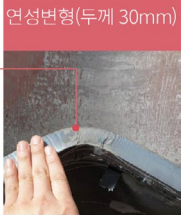
[Pos-H 1,200mm 적용, 5% 변형 → 특수모멘트 접합부]
