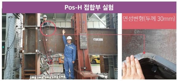
[Pos-H 1,200mm 적용, 5% 변형 → 특수모멘트 접합부]
